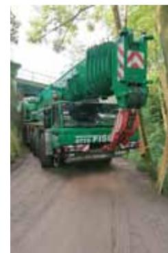
Der 220 t-Kran (hebt Lasten bis 220 t, hat ein Eigengewicht von 60 t) auf dem Weg zur Brückenbaustelle, hier beim zentimetergenauen Durchfahren der Unterführung bei der Rödelsmühle.
